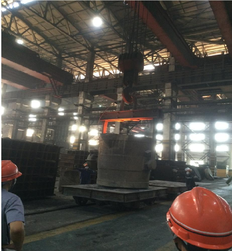
同一轨道上的两台过跨平车一前一后运送装有铁水的铁水包，其中后面一台过跨平车在转运铁水包的过跨平车在运行过程中，过跨平车的四只轮子和钢轨之间有拉弧现象，行车在吊运铁水包时，吊钩和龙门架的挂环间有拉弧现象。
