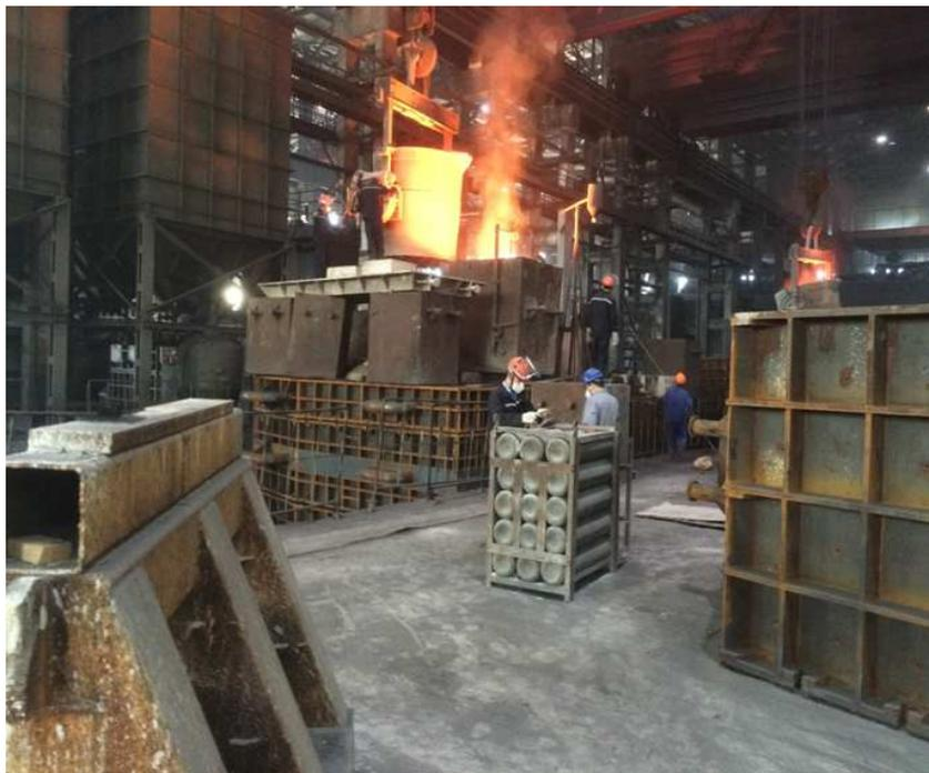
审核员在现场指出了重大安全生产事故隐患，铸造厂的现场调度在浇铸结束后，指挥将氮气钢瓶吊运至安全区域。
